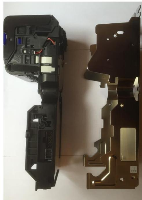
1. Открутите 3 винта с каждой стороны для отделения основной части и металлического кожуха.
